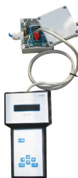
Programator wraz z modulem łączeniowym
